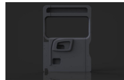
Schiebetürverkleidung mit zusätzlichem Stauraum
