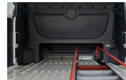
Laderaum mit Durchlademöglichkeit, praktisch für den Transport von langen Gegenständen
