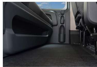
Seitenwandverkleidung mit Halterung für kleine und große Flaschen, Sitzbankvorderseite mit Stauraum
